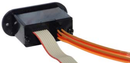
Rückseite des Schaltgebers mit eingesteckten Akkucontrollern
